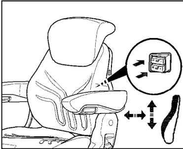
Durch Betätigung des oberen und unteren Schalters kann die Stärke der Vorwölbung im oberen und unteren Bereich des Rückenpolsters individuell angepasst werden.
