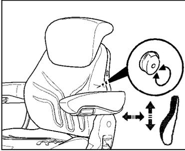
Durch Drehen des Handrades nach links oder rechts kann sowohl die Höhe als auch die Stärke der Vorwölbung im Rückenpolster individuell angepasst werden.
