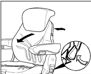
Zum Entrasten der Rückenlehne den Verriegelungshebel nach oben ziehen. Die Rückenlehne beim Entrasten nicht durch dagegen Drücken belasten.
