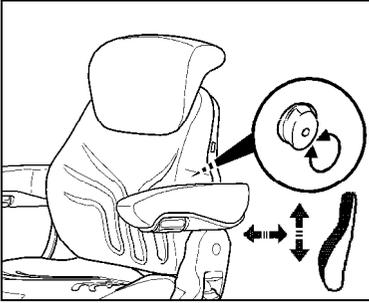
Door middel van het draaien van de bedieningsknop, naar links of rechts, kan zowel de hoogte evenals de sterkte van de bolling van het rugkussen aangepast worden.
