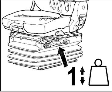
Das jeweilige Fahrergewicht muss bei stehendem Fahrzeug und belastetem Fahrersitz durch kurzes Ziehen des Betätigungshebels der automatischen Gewichts- und Höheneinstellung (Pfeil) eingestellt werden.
