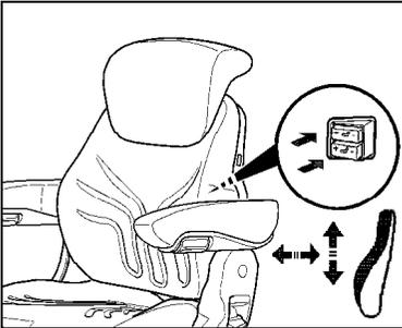
Druk op de bovenste en onderste schakelaar om de bolling van het bovenste en onderste gedeelte van het rugkussen individueel aan te passen.
