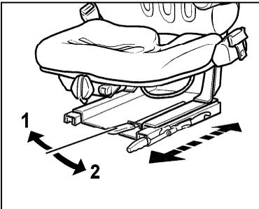
En determinadas condiciones de servicio (p.ej. conducir con remolque), es conveniente conectar la suspensión horizontal. De este modo, el asiento puede amortiguar mejor las sacudidas bruscas en el sentido de marcha.
