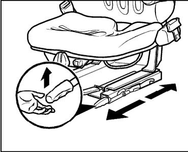
El mecanismo de regulación longitudinal queda libre accionando hacia arriba la palanca de bloqueo.
